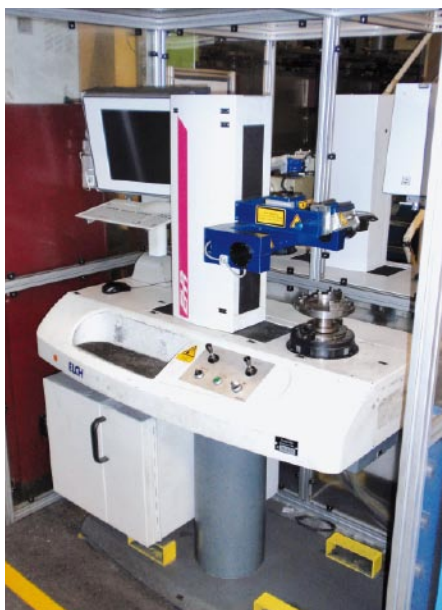
Gesamtansicht einer Präzisionsmessmaschine für die halbautomatische Vermessung von Synchronringen
