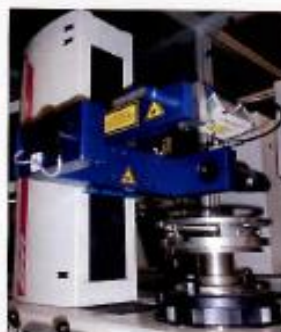
Die Präzisionsmechanik aus dem Hause Kelch ist in diesem Beispiel mit je einem 2D-Sensor (telezentrischer Aufbau) und einem 3D-Triangulationssensor ausgestattet. Für das Spannen eines Synchronrings wurde eine der Aufnahmen zur Bearbeitung entsprechende Spannvorrichtung entwickelt.
